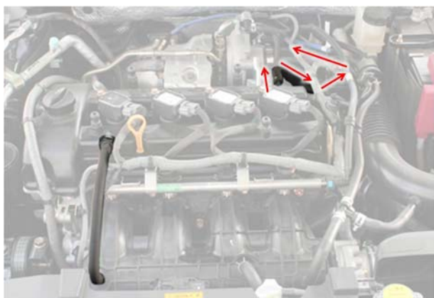
شکل 4-3 کارکرد سیستم تهویه بخارات روغن کارتل در شرایط غیر فعال بودن توربوشارژ
